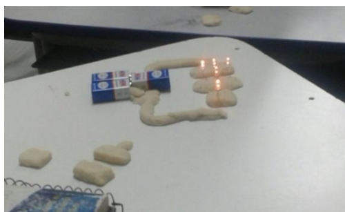
Figura 2 - Circuito elétrico montado, com associação em série, paralelo e misto. Fonte: Elaborado pelo autor (2025).
